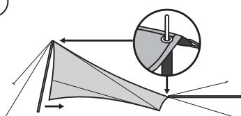
先端のグロメット(はとめ)にセンターPOールの先端をセットし、片側のセンターPOールを地面に垂直に立たせるように起こします。その後反対側のセンターPOールも立てます。
