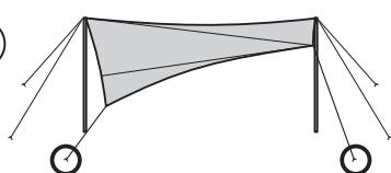
タープ四隅のループに張り繩を結びつけ、タープ本体上部の中心～タープ四隅の延長線上に伸ばし、張り繩の先端位置にペグを打ち込み、張り繩の先端をペグに引っかけます。
